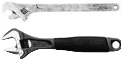
Der verstellbare Schraubenschlüssel von Johan Petter Johansson in seiner ursprünglichen Form 1892 und nach 100 Jahren Weiterentwicklung 1992.
